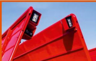
Ser. LED Rücklichter oben in den Bordwänden integriert. Auf Wunsch: LED Arbeitsscheinwerfer, Rückfahrkamera
